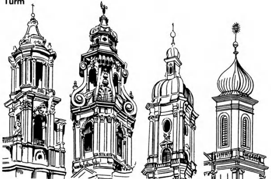
Öffnungen zwischen Säulen und Pilastern Rom, S. Agnese, 1666 Durchbrochener Volutenhelm Grüssau, 1735 Welsche Haube St. Gallen, Stiftskirche, 1755-67 Zwiebelturm Luzern, Jesuitenkirche, 1666-73
