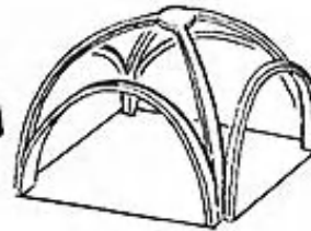
Kreuzrippen- gewölbe, gebüst
